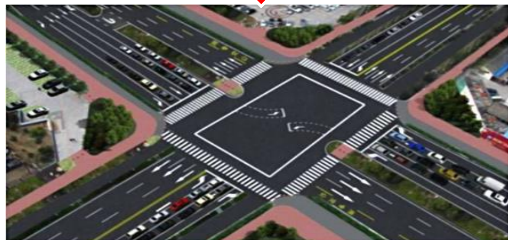
改造后：缩小交口转角路缘石半径，形成四面连贯的过街人行横道，减少过街距离，交口绿化丰富。
